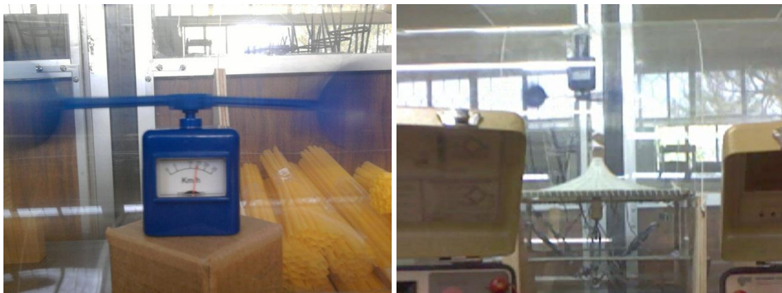
Figura 4.3. Medición de velocidad de viento vía anemómetro
