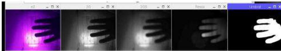
Figura 10. Proceso de detección de movimiento utilizando sustracción de fondo en condiciones de luz infrarroja.
