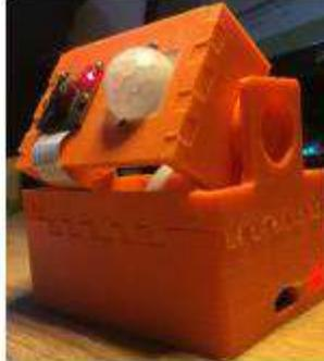
Figura 13. Carcasa impresa con los elementos de hardware.
