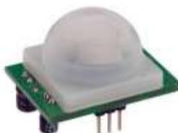
Figura 2. Sensor Piroeléctrico Infrarrojo PIR [12] [13].
