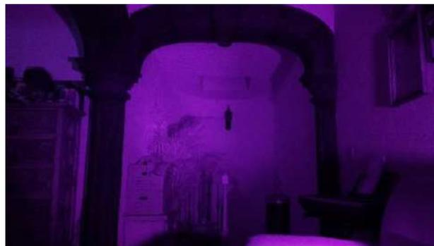
Figura 7. Imagen capturada por la cámara NoIR con iluminación infrarroja.
