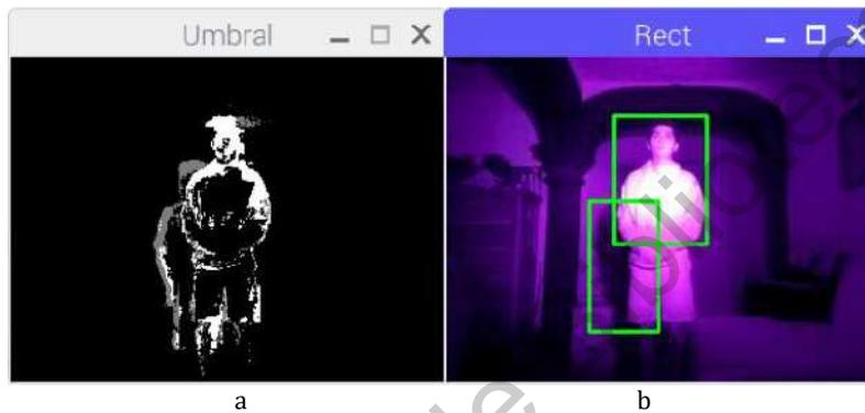
Figura 29. Detección de movimiento utilizando substracción de fondo MOG2 en condiciones de luz infrarroja.
