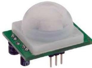
Figura 3. Sensor Piroeléctrico Infrarrojo PIR [28] [8].
