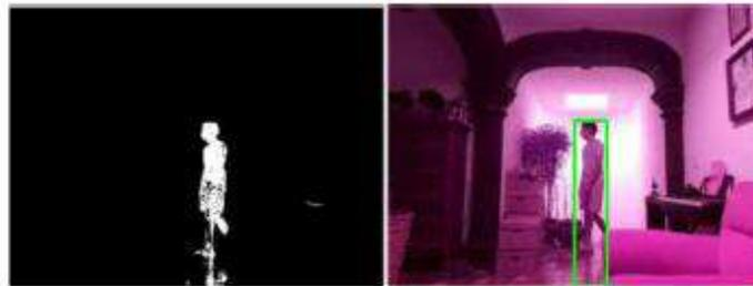
Figura 13. Detección de movimiento utilizando substracción de fondo KNN en condiciones de luz visible.
