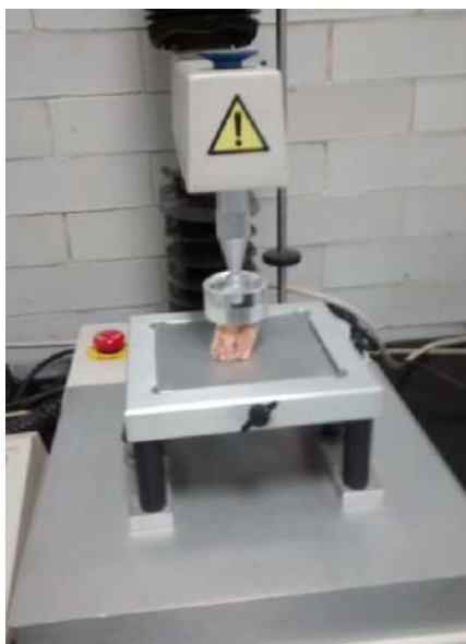
Figura 10 Muestra en el texturómetro.
