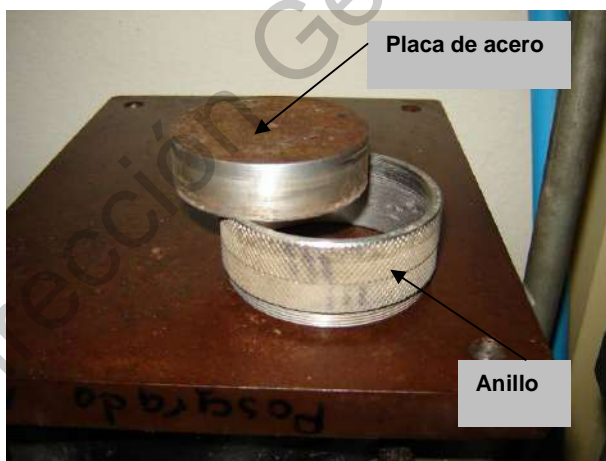
Figura 3.10 Anillo con placa para la compactación estática.
