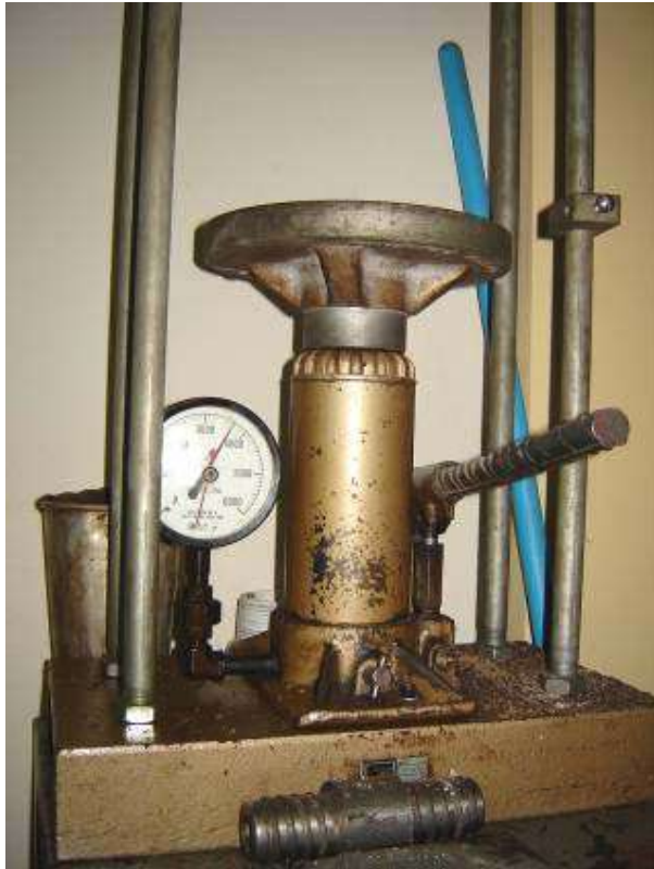
Figura 3.12 Gato hidráulico empleado para la elaboración de probetas.
