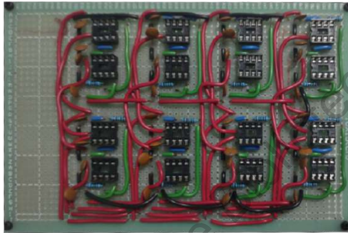
Figura 7.5: Circuito amplificador hecho en placa fenólica perforada.
