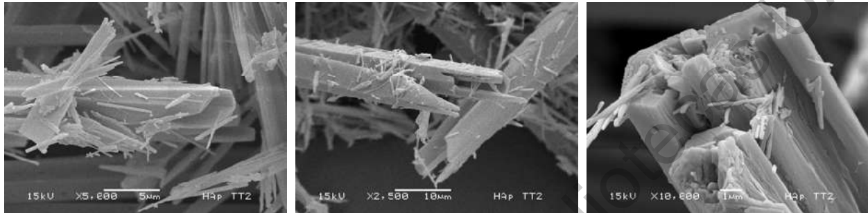
Figura 4.8 Micrografías de SEM correspondientes al tratamiento térmico de 750 °C durante 1.5 horas de las fibras de HAp.
