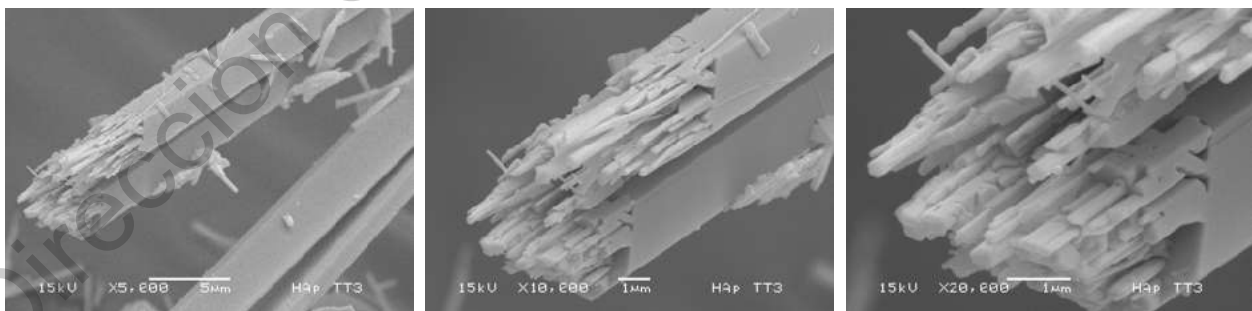
Figura 4.6 Micrografías de SEM correspondientes al tratamiento térmico de 600 °C durante 1 hora de las fibras de HAp.
