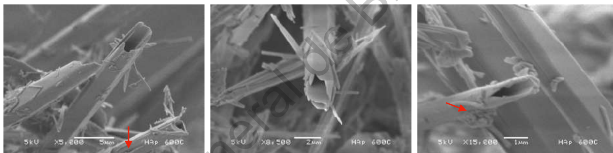
Figura 4.7 Micrografías de SEM correspondientes al tratamiento térmico de 600 °C durante 2 horas de las fibras de HAp.
