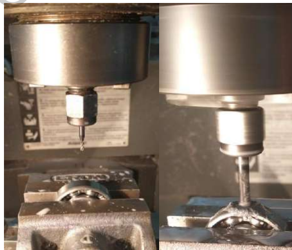
Figura 21. Manufactura de los fallos sobre el rodamiento (Autoría Propia).
