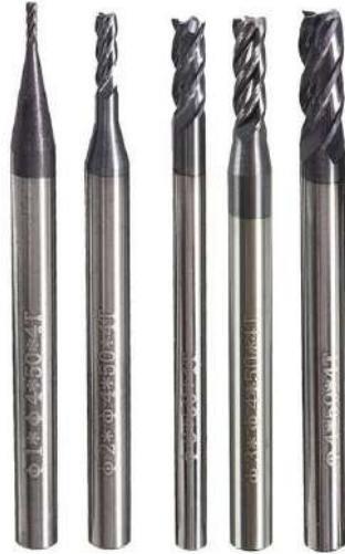
Figura 18. Cortadores de carburo H87 "MASTER C", 4g empleados para la inducción de la falla (Autoría Propia).
