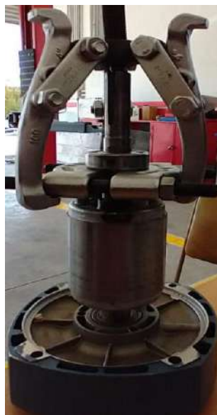
Figura 25. Extracción del rodamiento sobre el eje (Autoría Propia).
