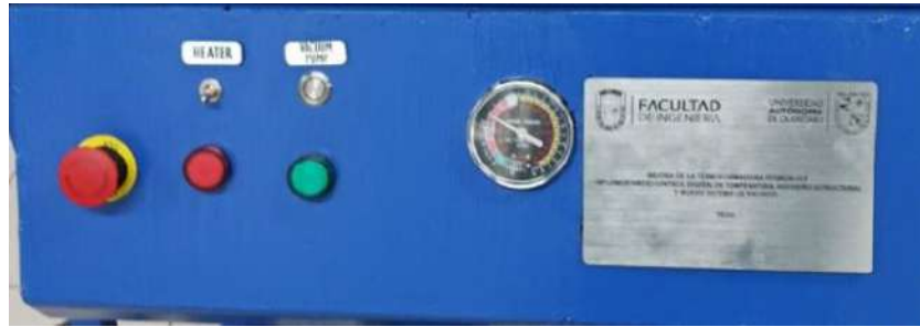
Figura 5.25: Tablero de control manual de termoformadora Peymon.
