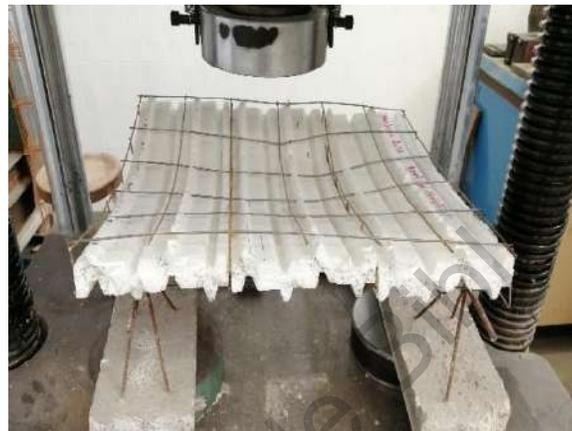
**Figura 22. Componente aligerante panel W con deformación irreversible.**
