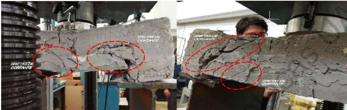
Figura 33. Patrón de grietas en cada claro del sistema Vigueta-Panel W.
