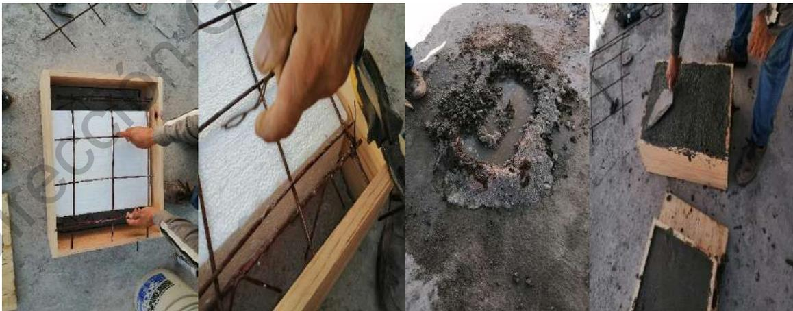
**Figura 23. A) Colocación de la malla electrosoldada B) Preparación de mezcla C) Colado de la muestra.**
