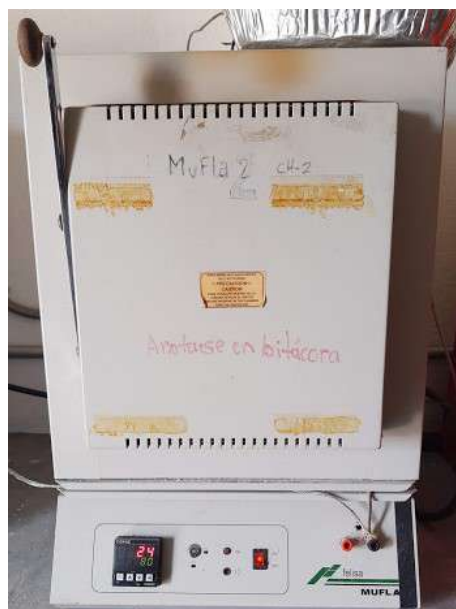
Figura 3.7: Mufla Felisa modelo FE-361. Fuente: CFATA-UNAM.
