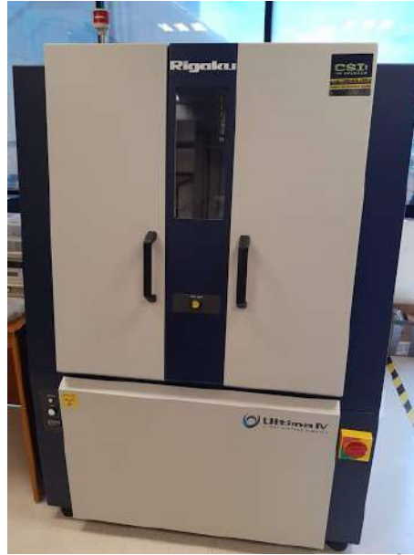
Figura 3.9: Difractómetro de rayos X Rigaku Ultima IV. Fuente: CFATA-UNAM.
