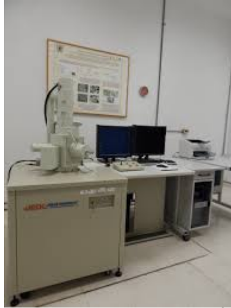
Figura 3.8: Microscopio Electrónico de Barrido JEOL JSM-6060. Fuente: CFATA-UNAM.
