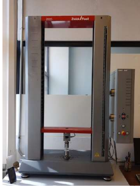
Figura 3.10: Máquina universal Zwick / Roell Z005. Fuente: CFATA-UNAM.
