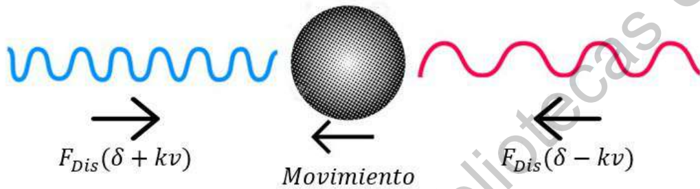
Figura 2.3: Interacción del átomo con los haces láser, de color rojo se representa el láser que se propaga en la misma dirección que el movimiento del átomo, mientras que en color azul se representa el láser que se propaga en dirección contraria a su movimiento. También se representan las fuerzas que se generan con la interacción átomo-láser, con sus respectivas correcciones por efecto Doppler y con una flecha que representa la dirección de la fuerza.
