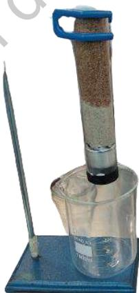
Figura 6 proceso de filtración del agua residual.
