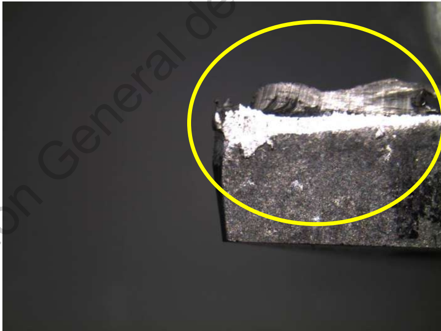
Figura 4.3Detalle del inserto "dañado" (desgaste de punta y cara). Puede observarse el nivel de desgaste debido al material acumulado (aluminio) señalado en la figura.
