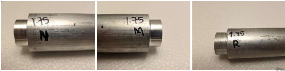
Figura 4.9. Barras maquinadas a 1.75mm de profundidad. De izquierda a derecha: herramienta "sana", herramienta con desgaste "medio" y herramienta "dañada".
