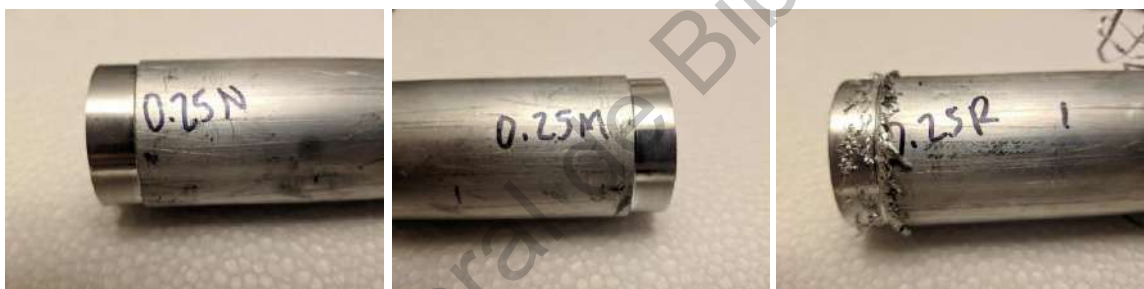
Figura 4.6. Barras maquinadas a 0.25mm de profundidad. De izquierda a derecha: herramienta "sana", herramienta con desgaste "medio" y herramienta "dañada".
