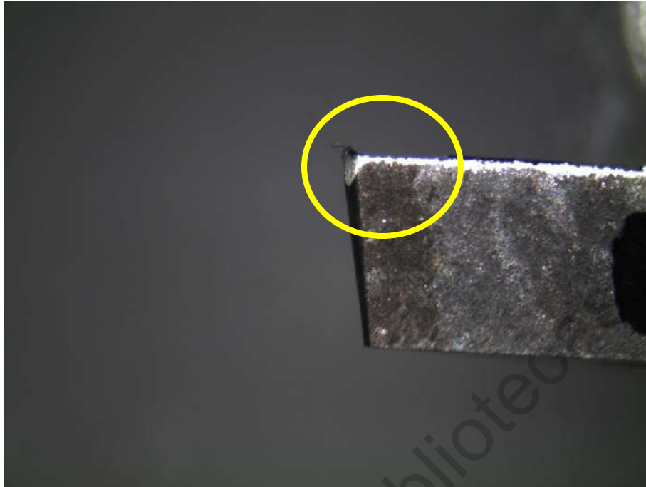
Figura 4.2. Detalle del inserto con desgaste "medio" (desgaste de punta). Puede observarse el nivel de desgaste debido al material acumulado (aluminio) señalado en la figura.
