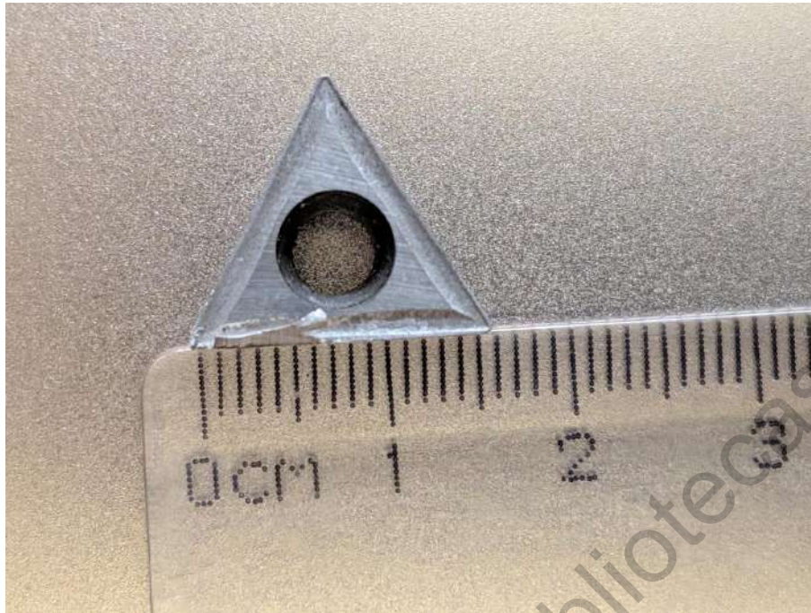
Figura 3.6. Fotografía del inserto "dañado" utilizado para las pruebas.
