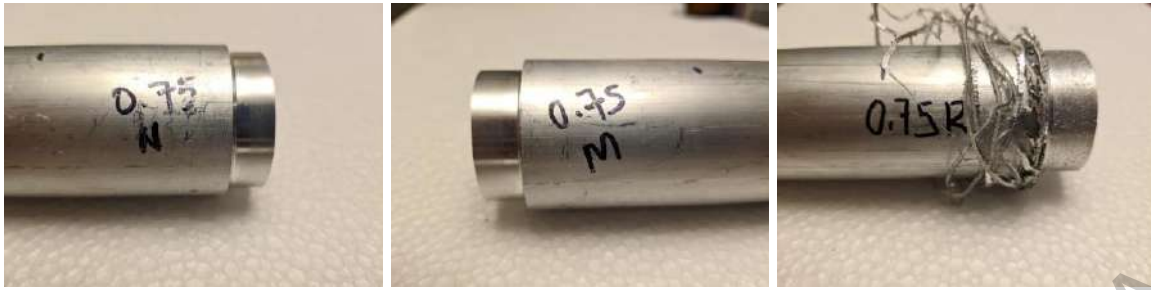
Figura 4.7. Barras maquinadas a 0.75mm de profundidad. De izquierda a derecha: herramienta "sana", herramienta con desgaste "medio" y herramienta "dañada".
