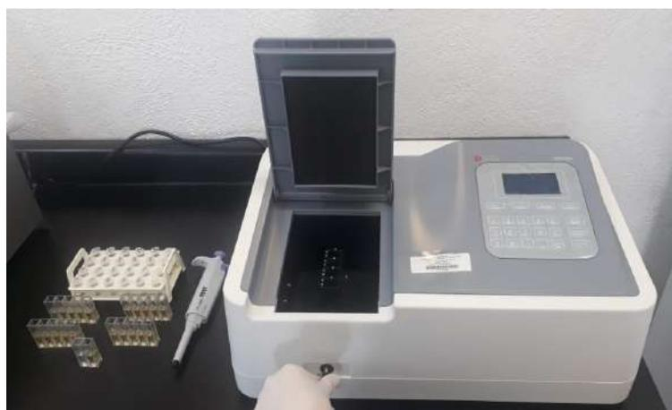
**Figura 4:** se observan las muestras a punto de ser analizadas por medio del espectrofotómetro (SP-V1100, DLAB Scientific CO, China).
