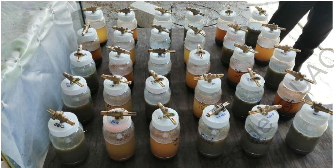
Figura 18. Sistema de biorreactores para la producción de biogás (Fuente propia).
