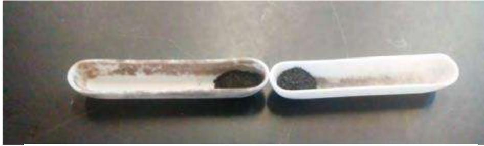
**Figura 4.4. Producto obtenido después de la reducción en horno tubular dentro de contenedores de alumina.**
