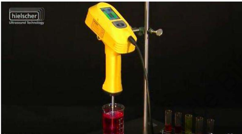
**Figura 4.1.** Aplicación del campo ultrasónico directamente al sol
