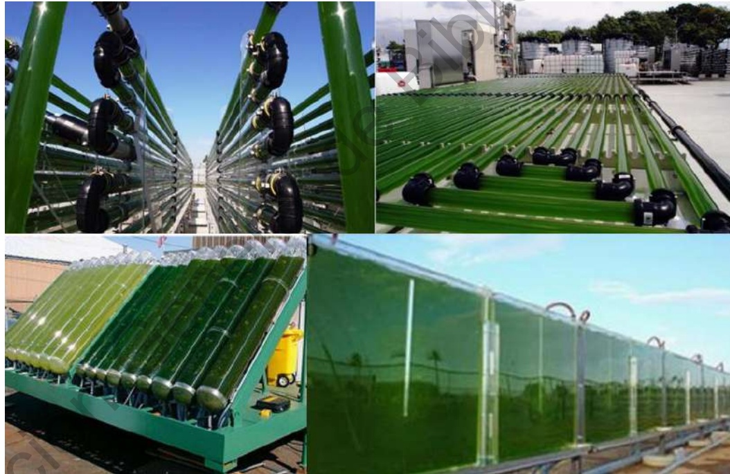
Figura 2. Arriba: Foto reactor tubular experimental “algaePRAC”, Wageningen University and Reserch, Países Bajos (Van Sprundel, 2012). Abajo-derecha: Reactor de columna de burbuja; abajo-izquierda: Fotobiorreactor de panel plano (Zhang et al., 2018).
