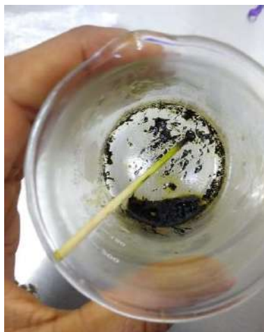
Figura 8. Extracto crudo de microalgas obtenido tras 4 h de refluxo y eliminación del solvente por medio de baño de agua.
