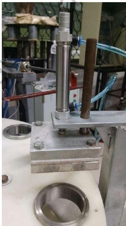
Figura 4.7: Resistencia para el sellado.
