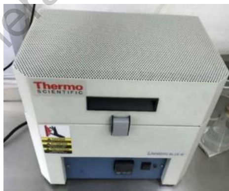
Figura 7.11. Horno tubular Thermo Scientific utilizado para los tratamientos térmicos a diferentes atmósferas.
