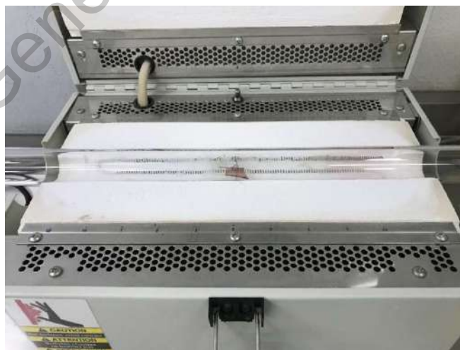
Figura 7.17. Fragmento de la película D1-11-12 sometido a tratamiento térmico a 200 y 300 °C.
