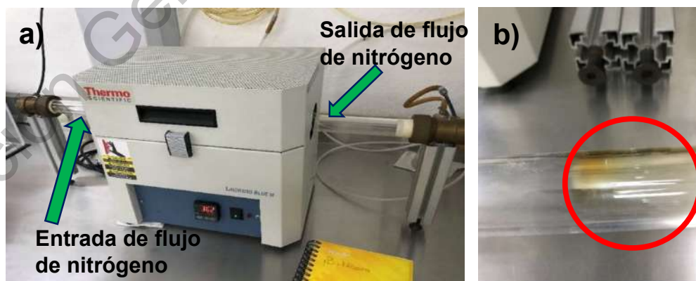
Figura 7.13. a) Entrada y salida de nitrógeno en el horno tubular y b) condensación de GeS al final del tubo de cuarzo.
