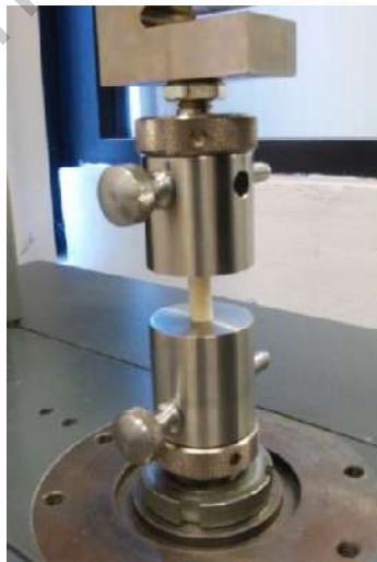
Figura 14. Probeta en el equipo durante la prueba de compresión.
