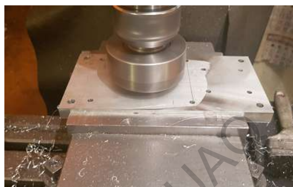
Figura 2.8: Acabado final de la base principal.
