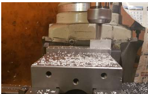
Figura 2.9: Escuadrado de la base del perfil Bosch.
