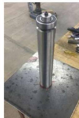
Figura 17 Barra con rodamiento
