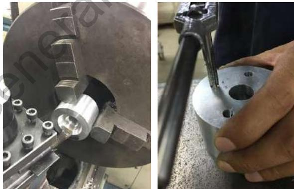
Figura 19 Maquinado de soporte rodamiento
