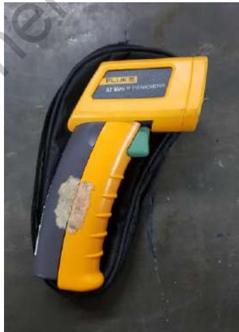
Figura 5.12: Termómetro láser infrarrojo marca FLUKE modelo 62 Max.
