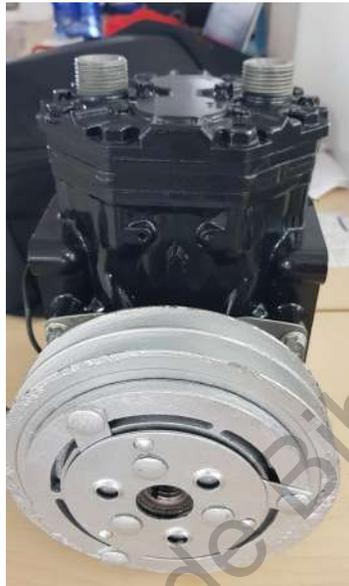
Figura 5.19: Compresor de aire acondicionado automotriz modelo York.
