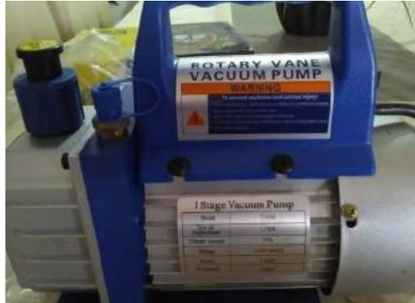
Figura 5.16: Bomba de vacío a utilizar para el cambio de refrigerante.
