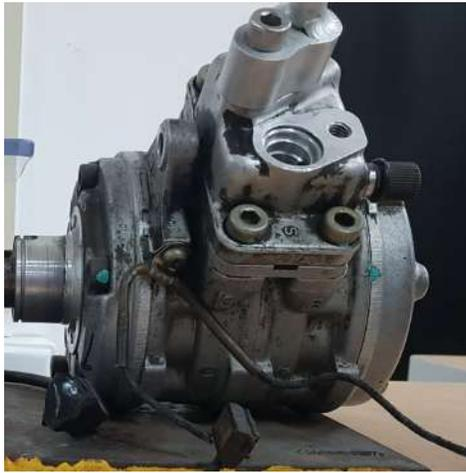
Figura 5.15: Compresor automotriz marca DENSO.
