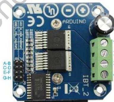
Figura 5.4: Puertos de entrada y salida del puente H modelo IBT-2.
