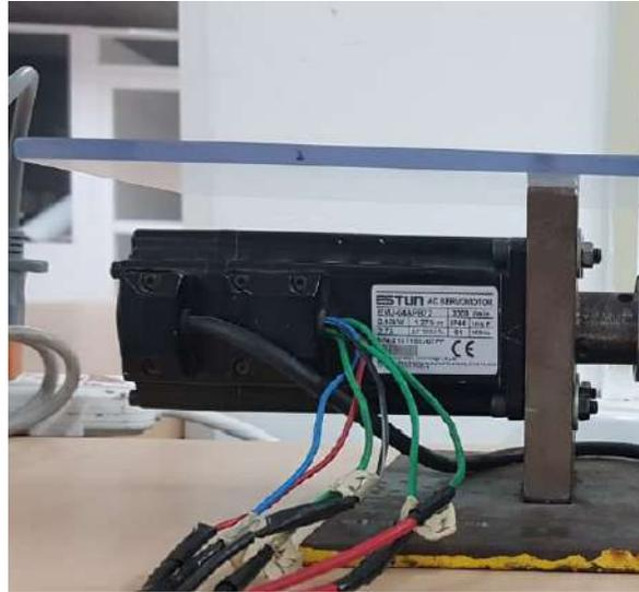
Figura 5.2: Motor PMSM marca ESTUN con los seis cables de alimentación visibles.
