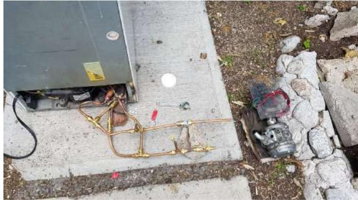
Figura 6.10: Conexión de la tubería del refrigerador con el nuevo compresor automotriz.
