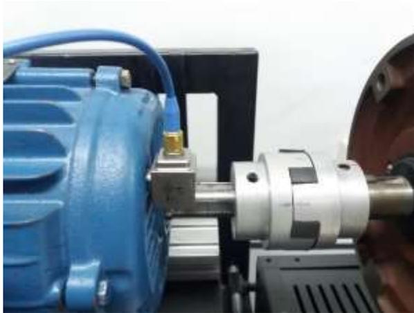
**Figura 4-2 Montaje del acelerómetro en la posición 1 cercana al rodamiento de la flecha del motor.**
