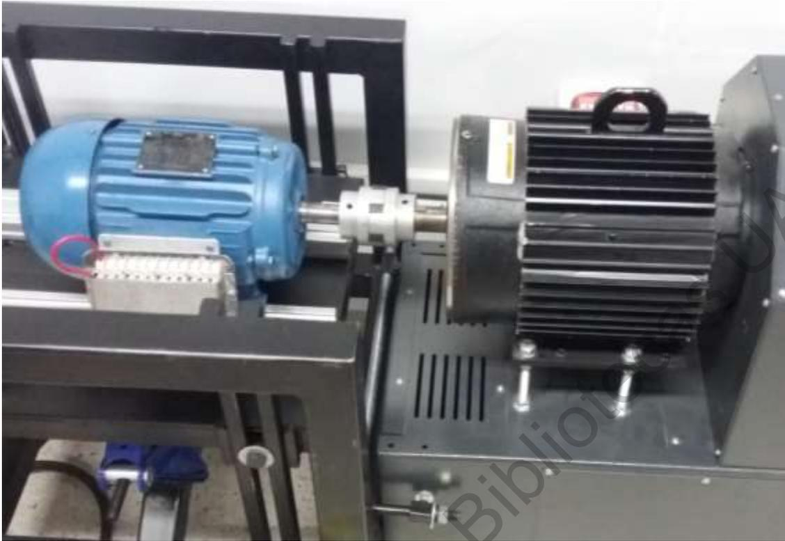
**Figura 3-4 Acople entre motor y freno dinamométrico.**
