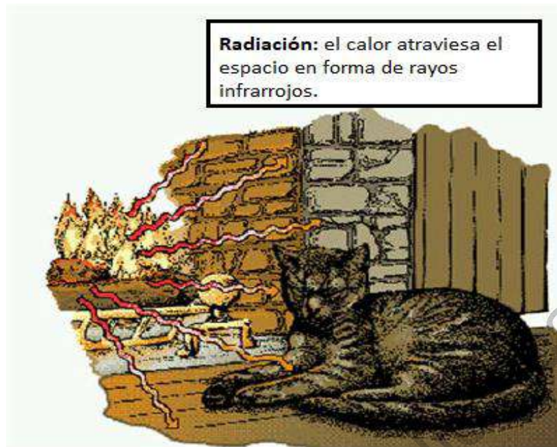
Figura 12. Transmisión de calor por radiación (Delgadillo et al., 2013).
