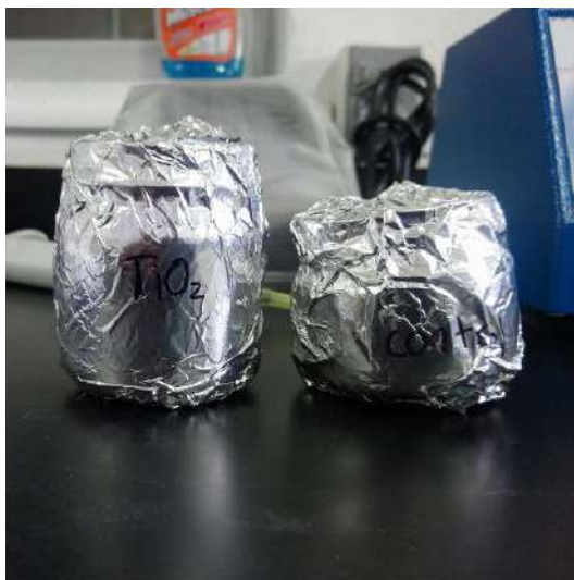
Figura 8. Probetas con el recubrimiento y envueltas.
