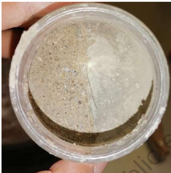
Figura 27. Acabado de la superficie de mortero convencional (izquierda) y acabado con recubrimiento (derecha).
