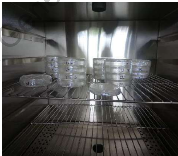
Figura 22. Incubación de las muestras de los tiempos t_1 , t_2 , t_3 , t_4 y t_5 de las probetas de mortero modificado y de control.
