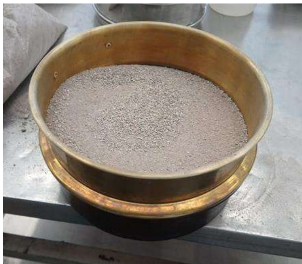
Figura 5. Cribado de arena por la malla No.20.
