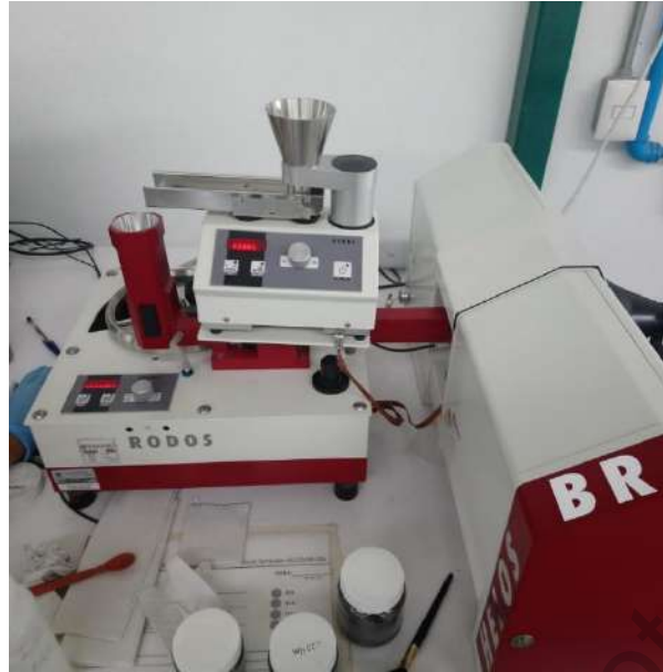
Figura 4. Estudio de la granulometría del material en el analizador de partículas.
