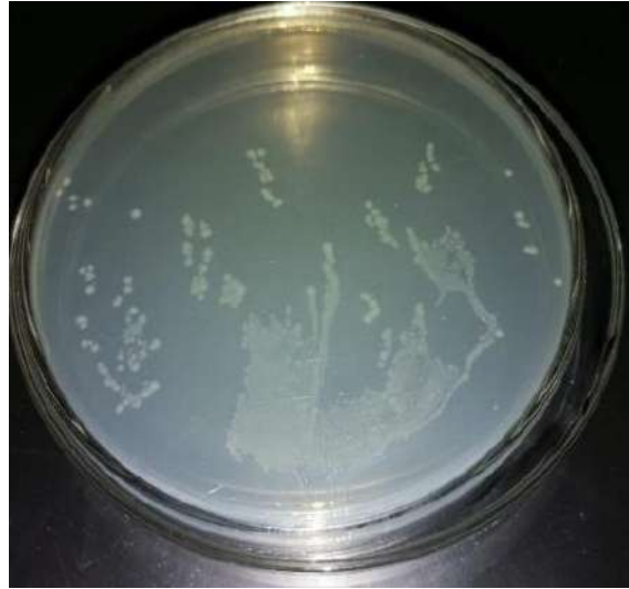
Figura 33. Plaqueo de muestra de probeta de mortero convencional a los 70 minutos de exposición a luz visible en ciclo número 4.
