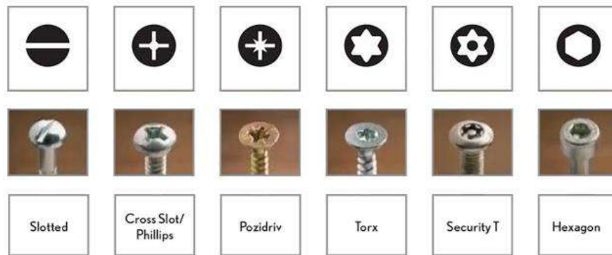
Figura 15 Tipos de ranuras en tornillos (Benítez, Información técnica sobre tornillos, 2017).
