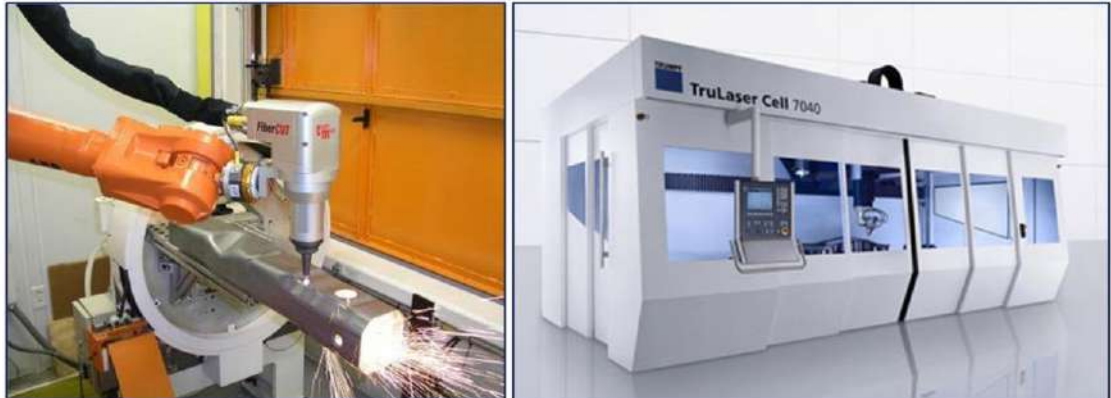
Figura 13 Brazo robótico realizando el corte de un tubo / Célula corte TruLaser Cell 7040 de la marca alemana Trumpf (Trade, 2017).
