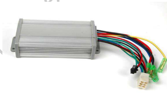
Figura 5 Controlador para bicicleta eléctrica (Bikelec, 2019).
