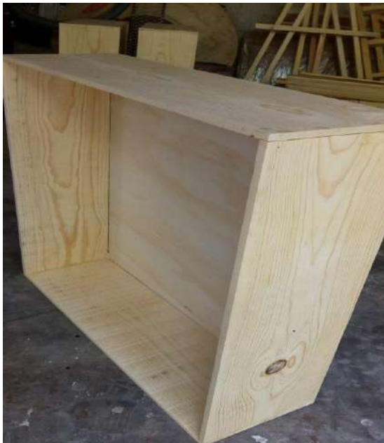
Fig. 47 Molde usado para la elaboración del lote uno de paneles.
