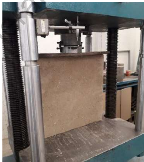
Fig. 23 Configuración de la prueba de compresión en la máquina universal.
