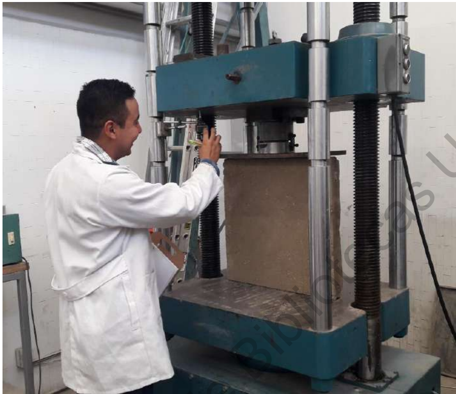
Fig. 17 Instrumentación de la máquina universal para medir las deformaciones.
