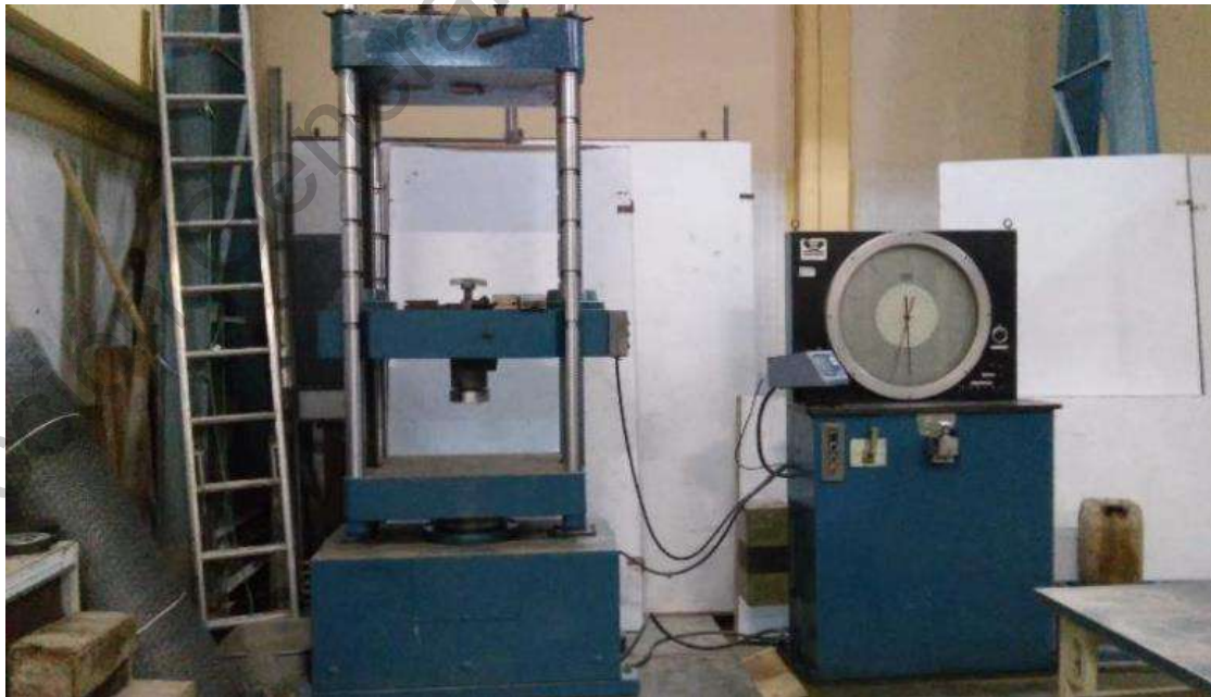
Fig. 16 Máquina universal utilizada para realizar las pruebas de compresión en paneles.
