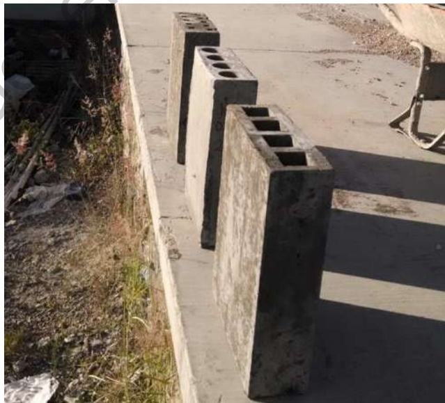
Fig. 5 Paneles expuestos a radiación térmica, (Escamilla, 2016).
