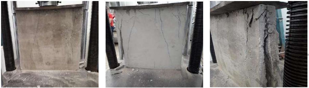
Fig. 28 Grietas y modos de falla presentados en paneles de ferrocemento.
