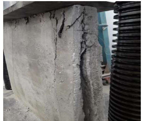
Fig. 56 Falla del espécimen.
