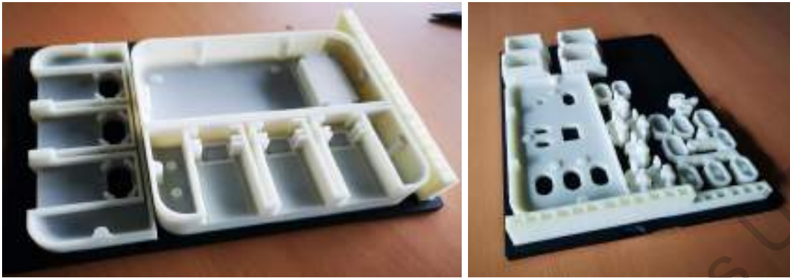
Figura 58.. Prototipo impreso en una Projet MJP 2500 de 3D Systems Fuente: Autoría propia
