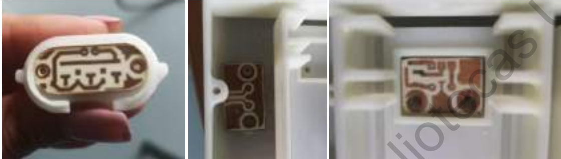
Figura 57. Verificación y rectificación de barrenos en placas del área de medicamentos Fuente: Autoría propia
