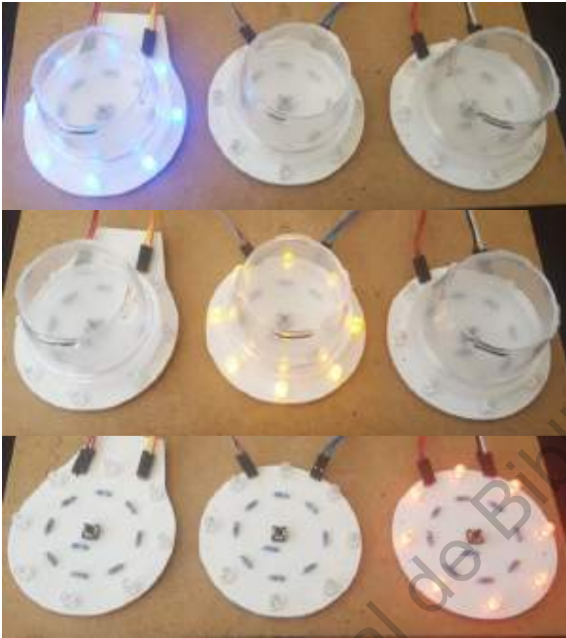
Figura 38. Esquema funcionando con intermitencia de LEDs continua en colores azul, amarillo y rojo. Fuente: Autoría propia
