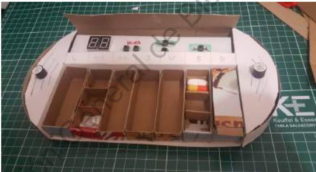
Figura 31: Modelo volumétrico de primera propuesta considerando algunos componentes electrónicos y pastillas de diverso tamaño Fuente: Autoría propia
