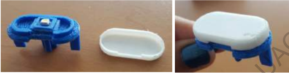
Figura 49. Base y tapa de botón con SMD LED sobre placa PCB. Fuente: Autoría propia
