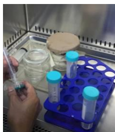
Figura 2 Proceso de esterilización por filtración en campana de bioseguridad.
