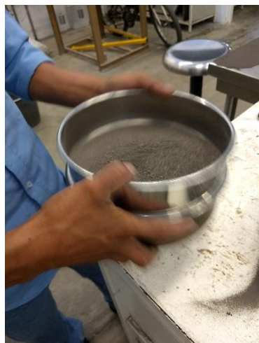
Figura 26: "Cribado de material en malla núm. 40." Fuente: Foto tomada por el autor.
