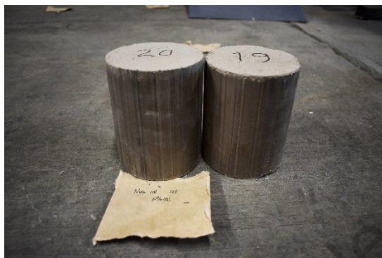
Figura 47: "Par de cilindros de suelo mejorado con 10% de Cal." Fuente: Foto tomada por el autor.
