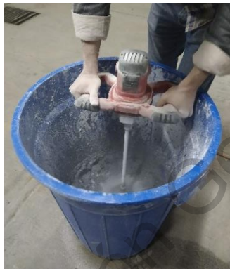
Figura 56: "Agregado de agua y polimero natural en proporción 3 litros:3ml" Fuente: Foto tomada por el autor.
