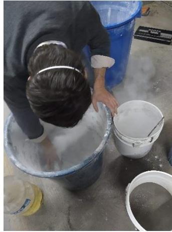
Figura 54: "Preparación de mezcla en agregados de cal y suelo arneado en proporción 1:3" Fuente: Foto tomada por el autor.
