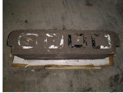
Figura 69: “Retiro de molde” Fuente: Foto tomada por el autor.
