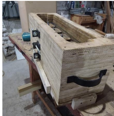
Figura 63: "Colocación de sistema de apertura horizontal por medio de tornillos" Fuente: Foto tomada por el autor.
