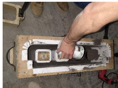
Figura 67: "Colocación de material por capas de 5cm." Fuente: Foto tomada por el autor.
