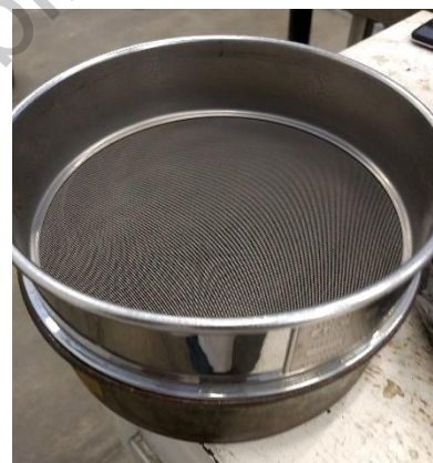
Figura 25: "Preparación de malla núm. 40." Fuente: Foto tomada por el autor.
