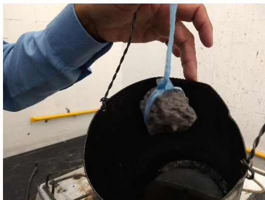
Figura 33: "Espécimen cubierto con parafina." Fuente: Foto tomada por el autor.
