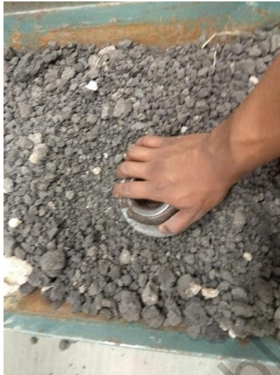
Figura 40: "Disgregado de material." Fuente: Foto tomada por el autor.
