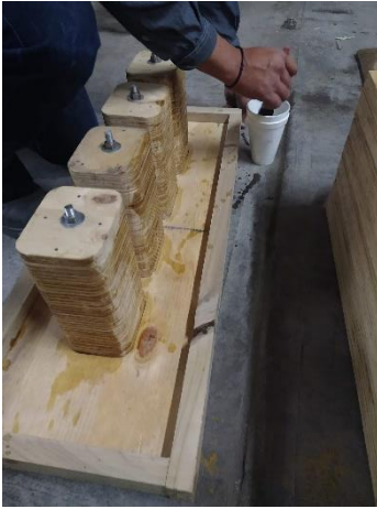
Figura 53: "Colocación de aceite como desmoldante" Fuente: Foto tomada por el autor.
