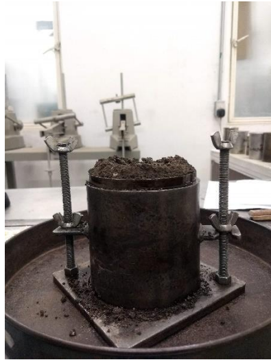
Figura 44: "Molde con suelo compactado sin collarín de extensión." Fuente: Foto tomada por el autor.
