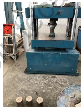
Figura 48: "Ensayo de Cilindros de Suelo Mejorado." Fuente: Foto tomada por el M.A.S. José Granados Navarro.
