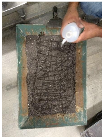
Figura 41: "Agregado de humedad determinada." Fuente: Foto tomada por el autor.
