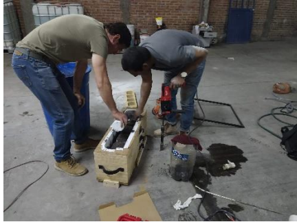
Figura 68: “Compactación por capas de 5cm” Fuente: Foto tomada por el autor.
