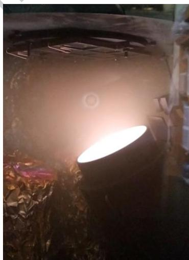
Figura 6.4. Interior de la cámara para la erosión catódica durante el proceso de depósito ZnTe:N.
