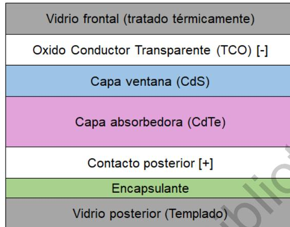
Figura 2.6. Estructura tradicional de una celda solar en la compañía *First Solar*.
