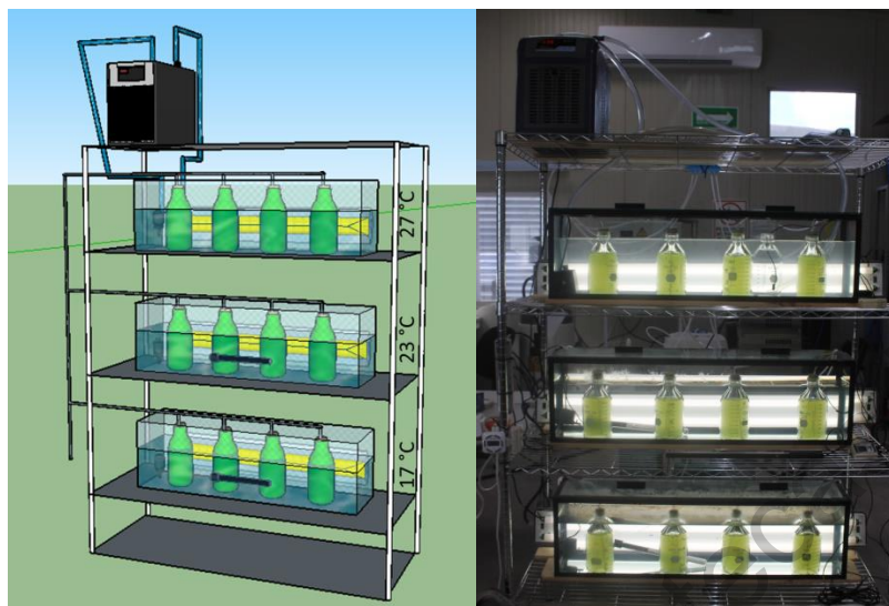
Figura 15: Diseño y sistema del cultivo de la microalga en agua residual de invernadero a distintas temperaturas.
