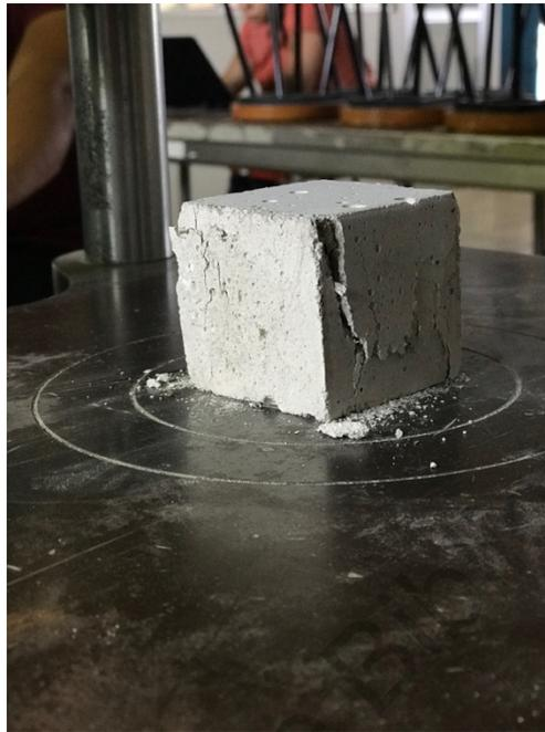
Ilustración 16. Falla en muestra después de prueba a compresión.
