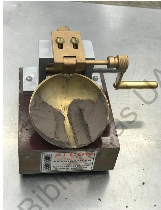
Ilustración 8. Prueba de Límite Líquido Casagrande.
