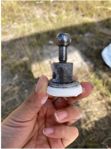
Ilustración 26. Falla presentada en la prueba
