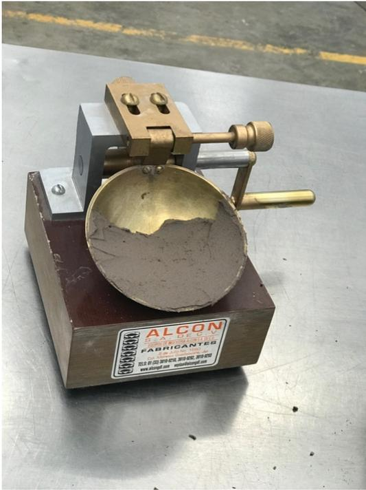
Ilustración 7. Realizando prueba de límite líquido.
