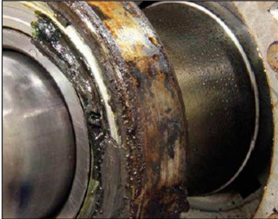
Figura 2.1 Fallas en rodamiento por calentamiento
