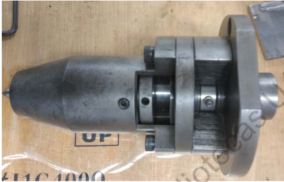
Figura (3.3) Porta punzón para proceso de corte.
