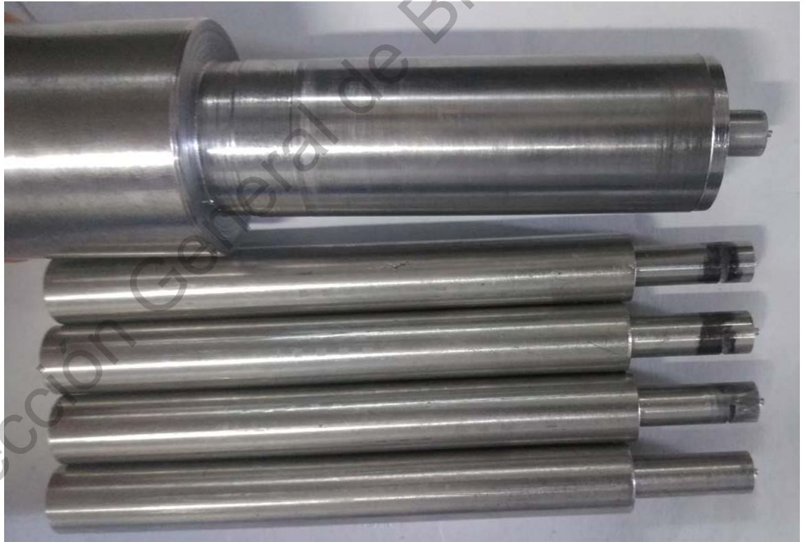
Figura (3.7) Punzones de corte con una mitad de daño.
