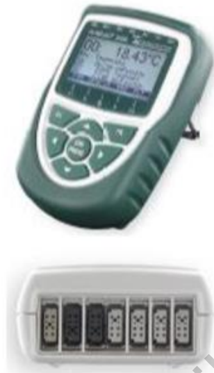
Figura 4.6. Aparato portátil de medición de temperatura, presión, humedad relativa.
