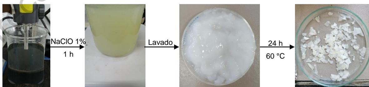
Figura 6. Diagrama general de la producción de nanocristales de celulosa (parte 2).
