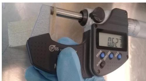
Figura 11. Medición del espesor de las películas.
