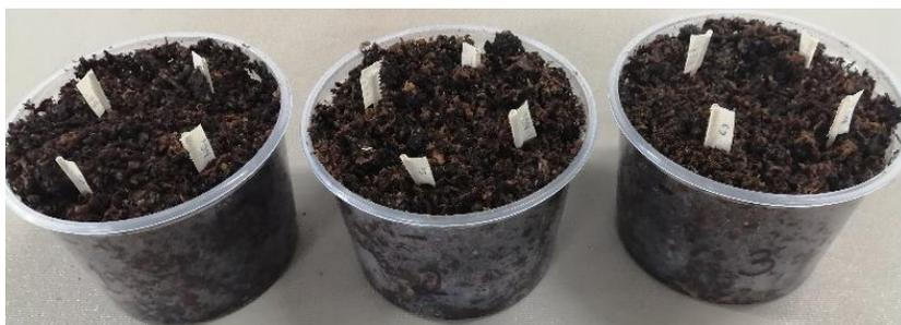
Figura 13. Ensayo de compostabilidad.
