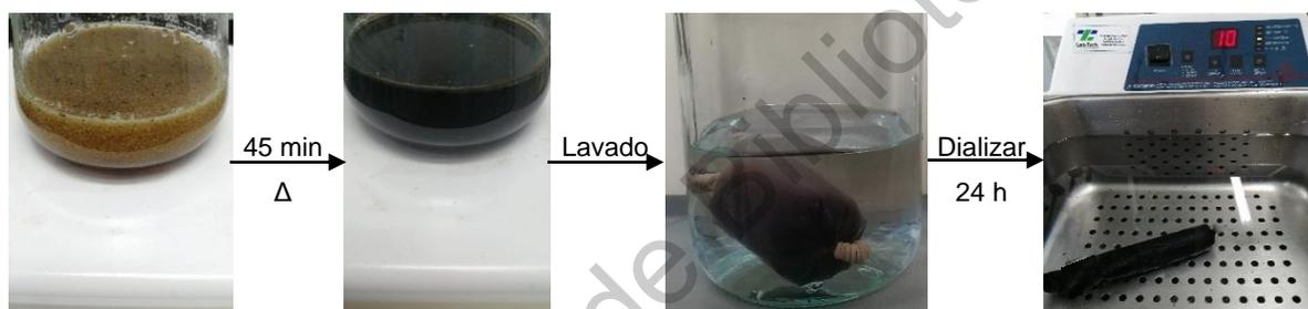
Figura 5. Diagrama general de la producción de nanocristales de celulosa (parte 1).
