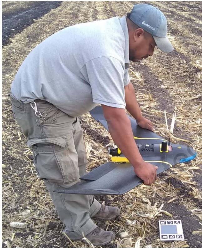
Figura 11. Calibración de los valores de reflectancia con la ayuda del objetivo de campo
