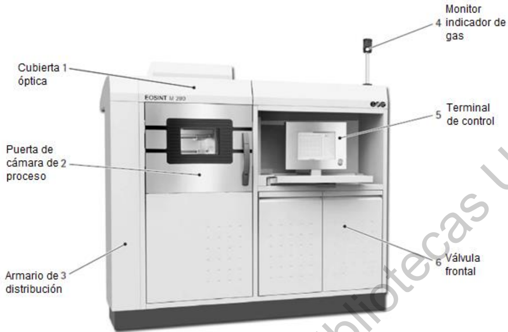
Figura 3.2-1 Componentes frontales de impresora EOSINT M 280 [7].
