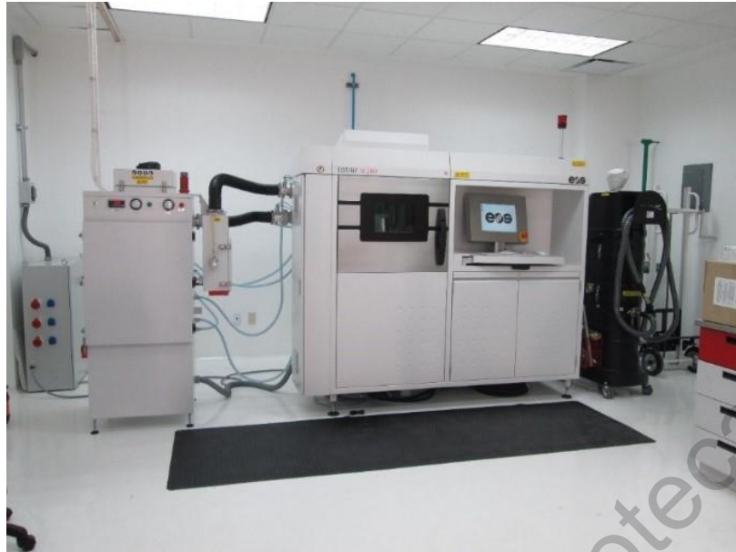
Figura 3.3-1 Impresora EOSINT M 280, laboratorio de manufactura aditiva CIATEQ A.C.
