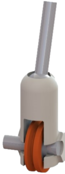
Figura 6.1: Ensamble de las piezas diseñadas en SolidWorks ® para el sistema de poleas.
