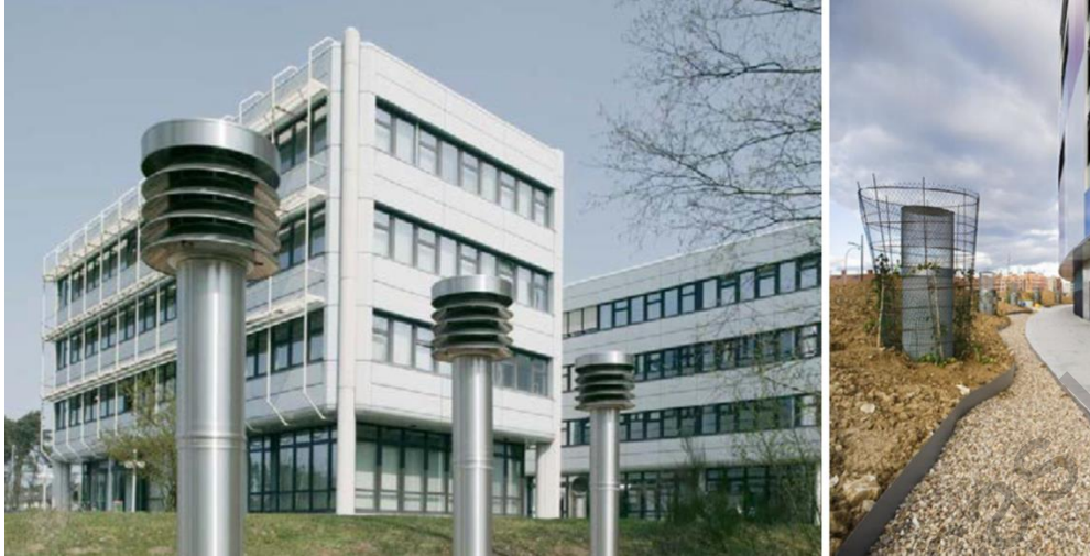
Figura 24 Ejemplos de torres de aspiración (Dias, 2018).
