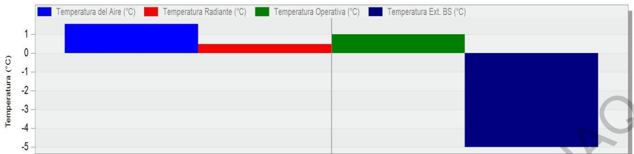
Figura 66 Grafica de Diseño de Calefacción del edificio CATAS sin ningún sistema de climatización. Fuente: elaboración propia con Energy Plus.
