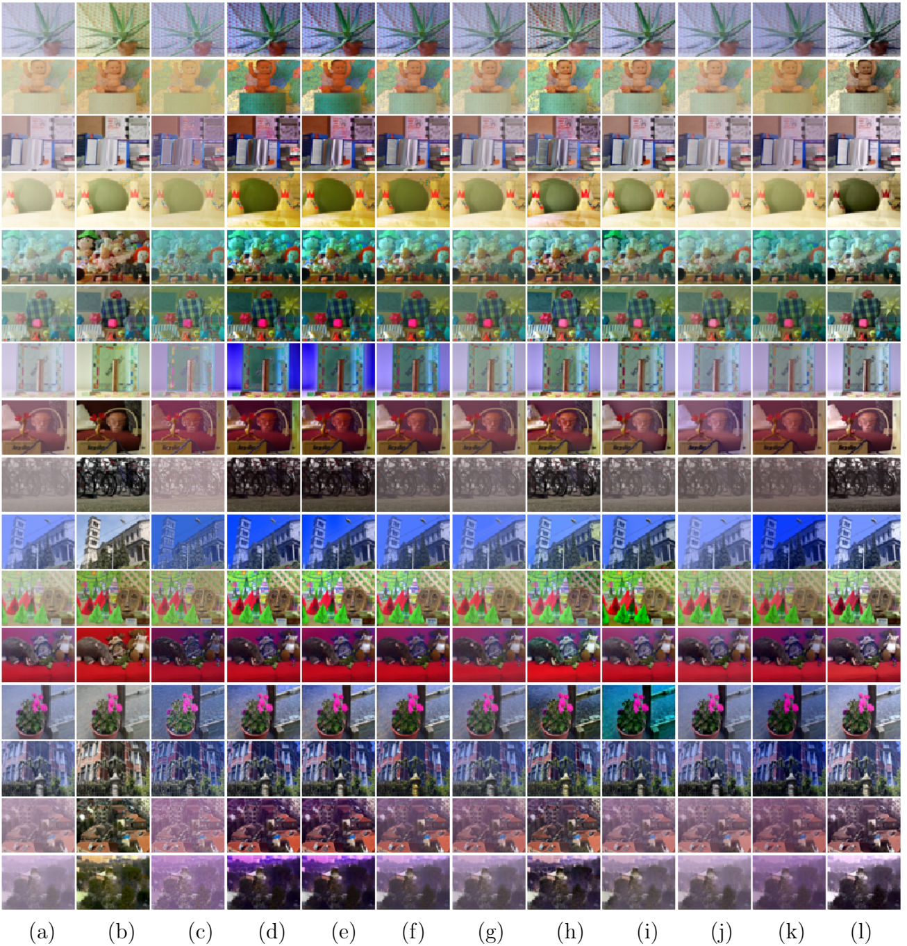
Figura 4.2: Comparación de los resultados obtenidos de las imágenes sintéticas por los diez métodos: (a) imágenes originales, (b) imágenes con neblina simulada, (c) Tarel et al. [6], (d) He et al. [7], (e) Pang et al. [8], (f) Gibson et al. [9], (g) Zhu et al. [10], (h) Berman et al. [11], (i) Ren et al. [12], (j) Cai et al. [13], (k) Li et al. [14], (l) Método propuesto [Creación propia].
