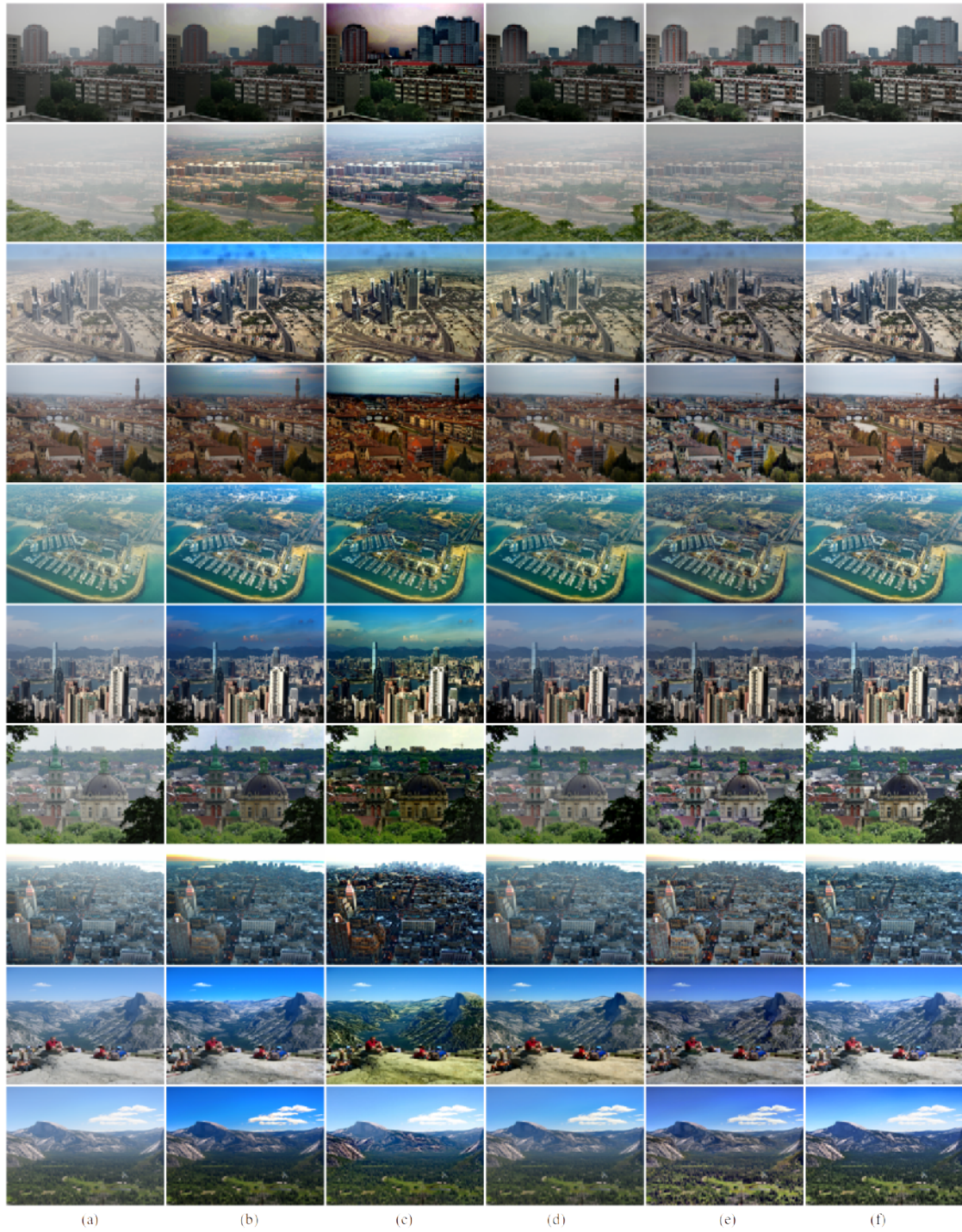
Figura 4.5: Conjunto de diez imágenes del mundo real restauradas con diferentes métodos de dehazing. (a) Conjunto de imágenes exteriores con neblina, (b) restauración usando He et al. [15], (c) restauración usando Berman et al. [11], (d) restauración usando Ren et al. [12], (e) restauración usando Galdran et al. [16], (f) restauración usando el método propuesto [Creación propia].
