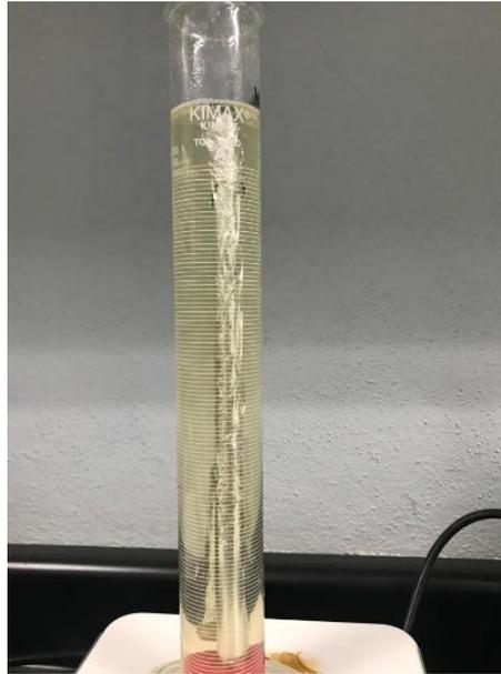
*Figura 8.* Impregnación de membrana cerámica con solución de quitosano.
