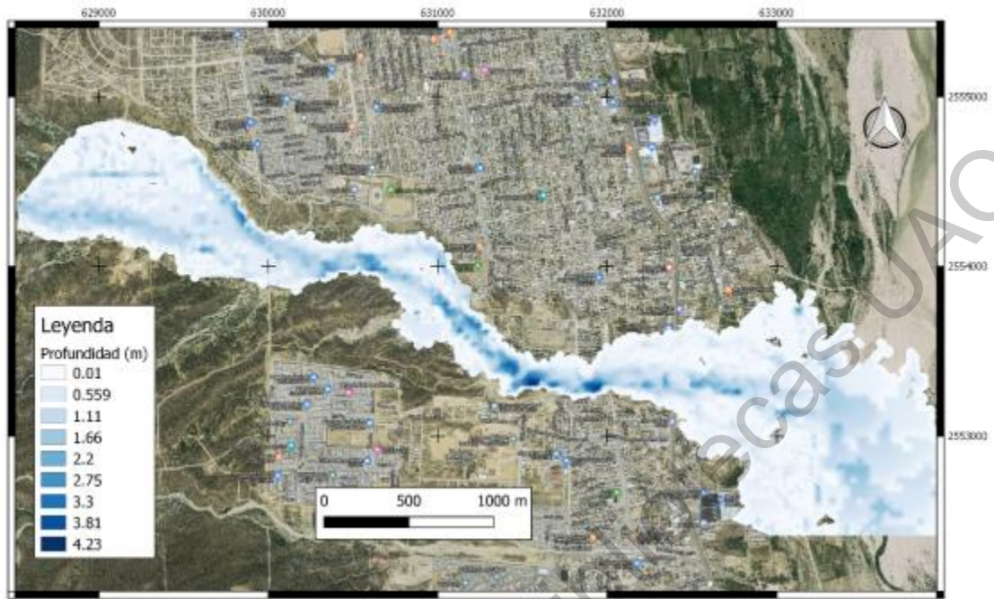
Figura 37 Variación de valores de altura del agua para el arroyo El Saltito periodo de retorno de 500 años
