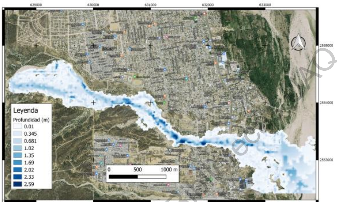
Figura 25 Variación de valores de altura del agua para el arroyo El Saltillo periodo de retorno de 10 años
