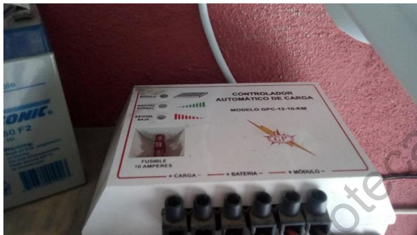
Figura 3.8. Controlador de carga.
