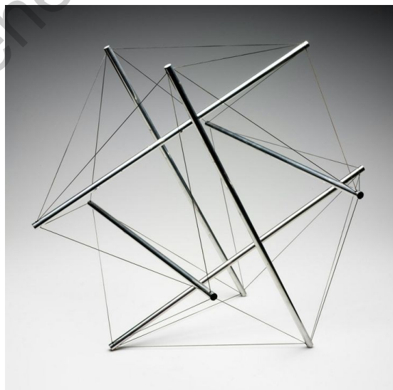
Figura 2.3. Sistema tensegrity octaedro, (Skelton y De Oliveira, 2009).
