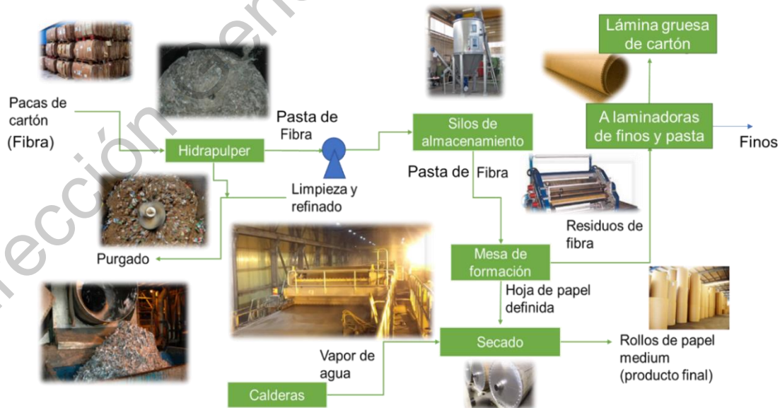
Figura 1. Diagrama general del proceso de reciclado de cartón.
