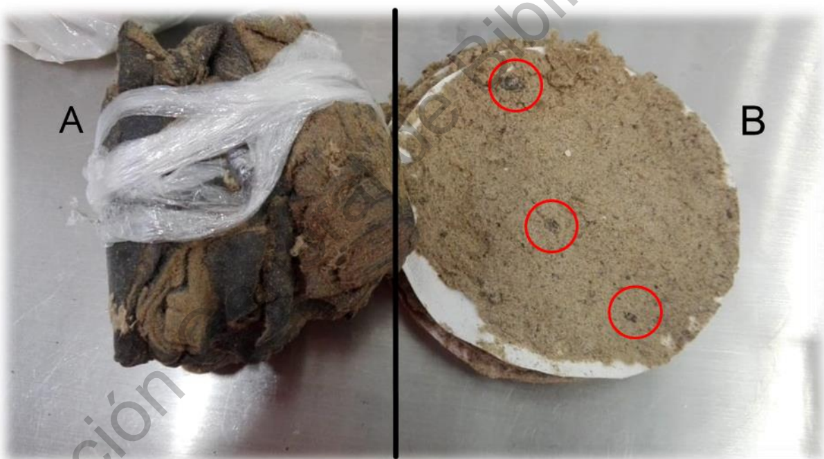
Figura 5. Cúmulos de polímeros adhesivos o stickies. A: sticky acumulado en el proceso de secado. B: stickies incrustados en la pasta de cartón (algunos se muestran en los círculos rojos)
