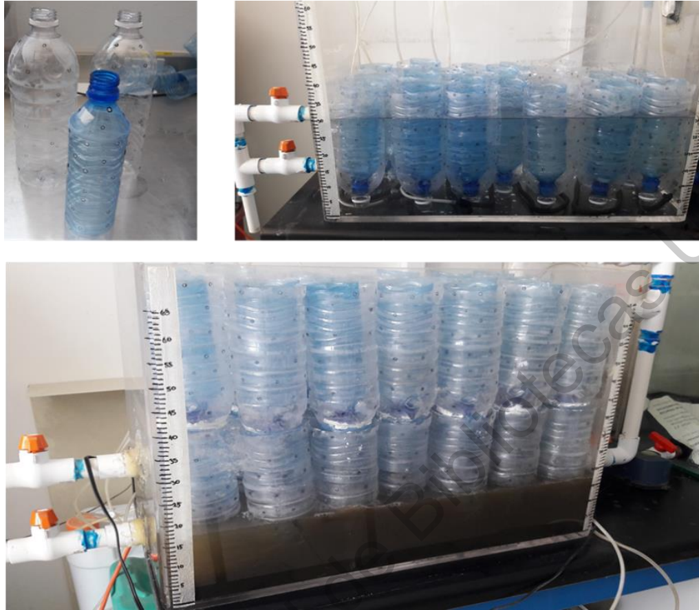
Figura 12. Ensamblado del medio de soporte PET
