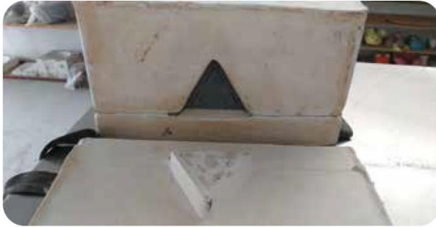
Ilustración 75. Desmontamiento de molde.
