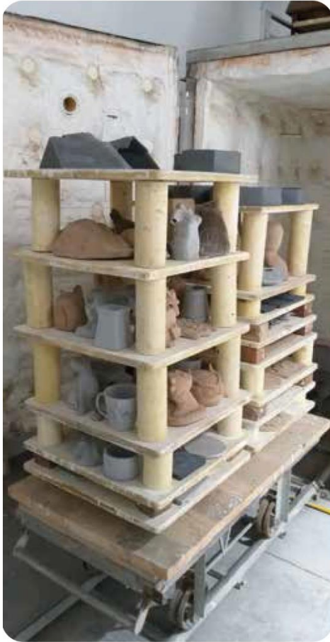
Ilustración 82. Acomodo de piezas en horno.
