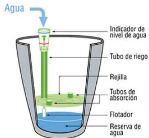
Ilustración 6. Sistema de riego por subirriación (Sepúlveda, 2016).
