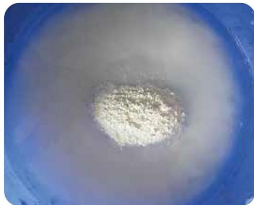
Ilustración 59. Preparación de yeso.
